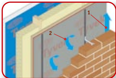
rys. A Konstrukcja ściany szkieletowej
