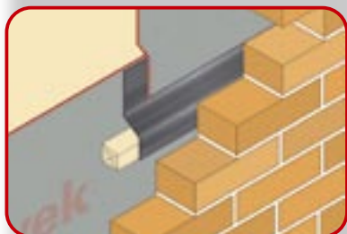
rys. C Zakończenie pierwszego pasa membran
